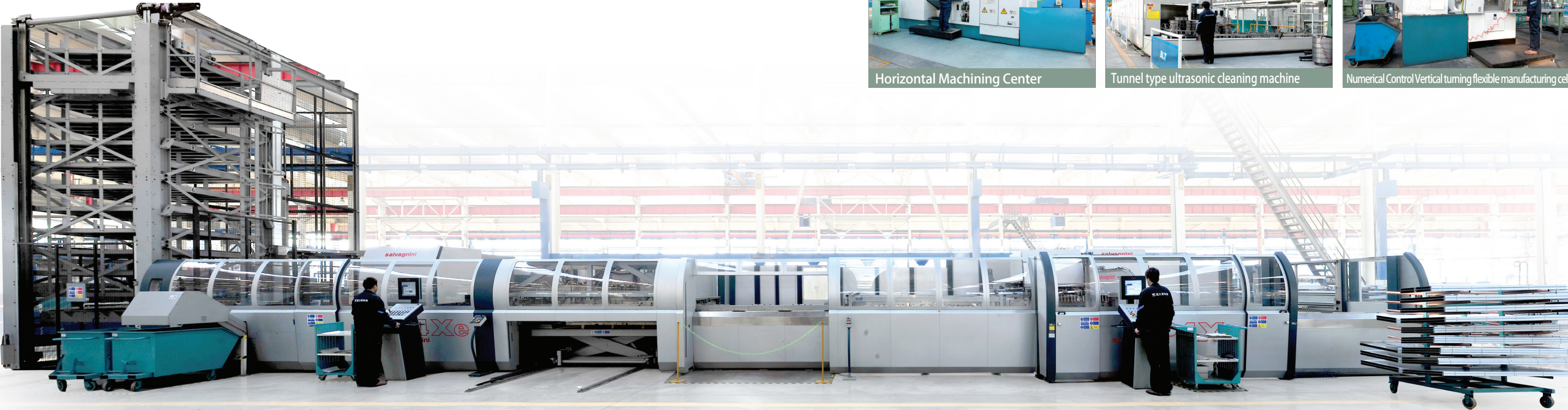
Salvagnini's(S4+P4) bộ dây chuyền linh hoạt sản xuất tấm kim loại
